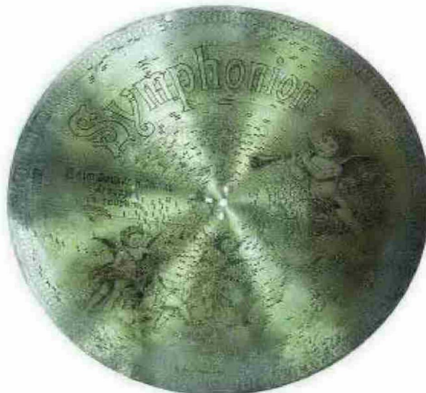
▲ Disco perforado. Imagen de un disco metálico perforado de 1890 para ser usado en una caja de música, de la casa alemana Symphonion. :: IDEAL
